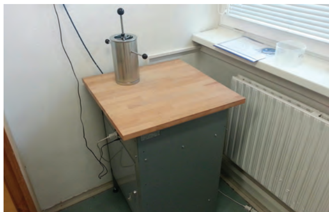
Obr. 2: Přístroj pro stanovení odporu proti proudění vzduchu
