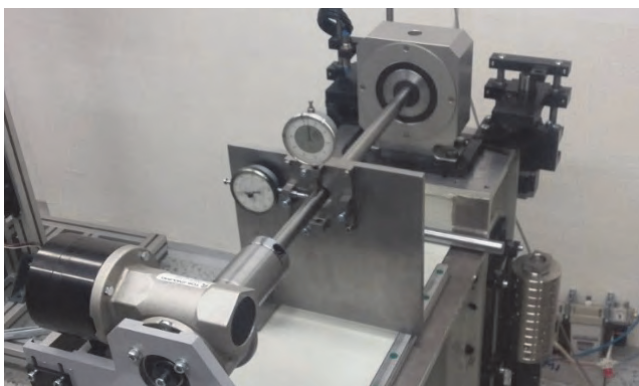
Obr. 9: Nastavení pozice vyrovnávací jednotky
