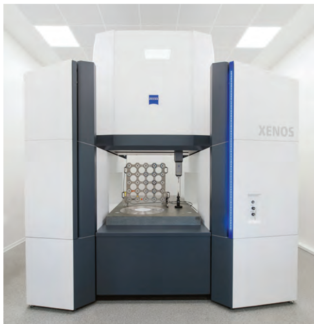
Obr. 6: Instalace souřadnicového měřicího stroje Zeiss Xenos v ČMI OI Radiová.
